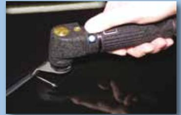
Für die RODCRAFT UNICUTTER führen wir ein umfassendes Zubehörprogramm mit Messern zum Heraustrennen von Autoscheiben, mit Sägeblättern, mit denen man sogar reaktionsfrei Tauchschnitte in glattes Blech oder andere Materialien machen kann, (S63 und S80) mit Schabern zum Ablösen von Kleberesten, z.B. nach der Demontage von Autoscheiben etc...
