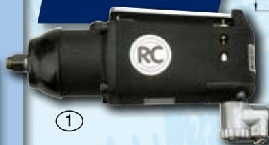
3/8" Schlagschrauber für enge Stellen (Motorräder). Wippenschalter für R/L Einhandbedienung. Eingebautes Leistungsreduzierventil mit 8-Rasten und um 360° drehbarem Lufteinlaß.
