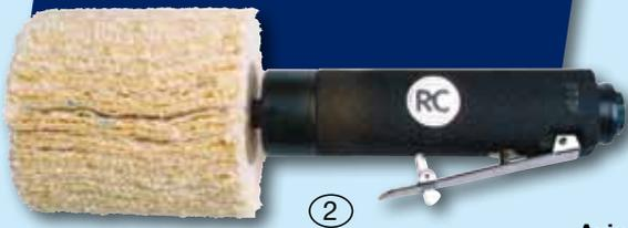
Polierer mit kräftigem Planetengetriebe und Abluft nach hinten (Möglichkeit zum Anschluß eines Abluft-Schalldämpfer-Systems). Die 100 x 100 mm Sisalwalze ist besonders gut für lange Flächen geeignet z.B. Vierkantprofile aus Kunststoff, Holz oder Aluminium, wie Fenster, Rahmen etc. Der Handgriff kann mit einem Kälteschutz überzogen werden.
