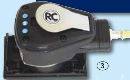
Kleiner Einhand-Schwingschleifer mit 5 mm Schleifhub und bewährtem hartverchromten Luftmotor. Die ungelochte Klettschleifplatte ist ebenfalls mit Klammern ausgerüstet. Abluftführung nach hinten.
