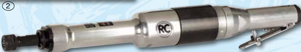
Langer großer Stabschleifer mit 6 mm Spannweite und Abluft nach unten (mittig zur Seite weg). Diese Form erlaubt die kraftvolle beidhändige Bedienung für grobe Arbeiten.
