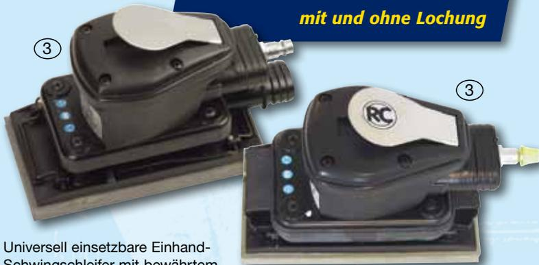
Universell einsetzbare Einhand-Schwingschleifer mit bewährtem hartverchromten Luftmotor und Abluft nach hinten. Die gelochte Klettschleifplatte ist ebenfalls mit Klammern ausgerüstet. Modell 7710V ist mit einer ungelochten Klettplatte ausgestattet, Modell 7715V hat eine gelochte Klettplatte und einen flachen Sauganschluß Nenndurchmesser 29 mm für die Benutzung mit einer externen Absaugung.
