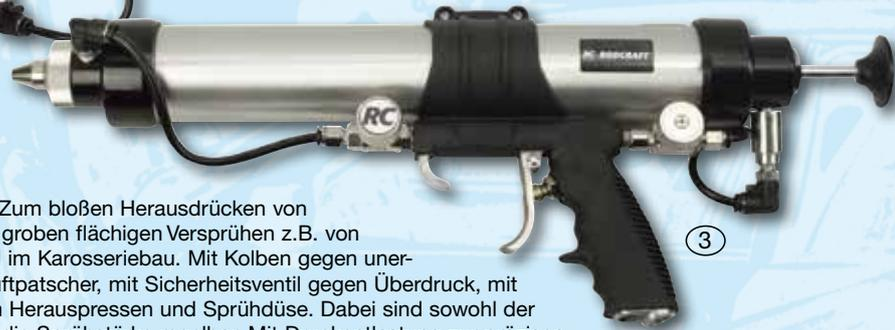
Echte Universalpistolen. Zum bloßen Herausdrücken von Materialraupen und zum groben flächigen Versprühen z.B. von Nahtabdeckungsmaterial im Karosseriebau. Mit Kolben gegen unerwünschte Kartuschen-Luftpatscher, mit Sicherheitsventil gegen Überdruck, mit Düse aus Kunststoff zum Herauspressen und Sprühdüse. Dabei sind sowohl der Materialausfluß als auch die Sprühstärke regelbar. Mit Druckentlastung zur präzisen Endabschaltung ohne nachträglichen Materialaustritt.
