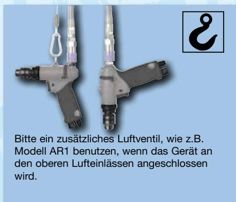
Bitte ein zusätzliches Luftventil, wie z.B. Modell AR1 benutzen, wenn das Gerät an den oberen Lufteinlässen angeschlossen wird.
