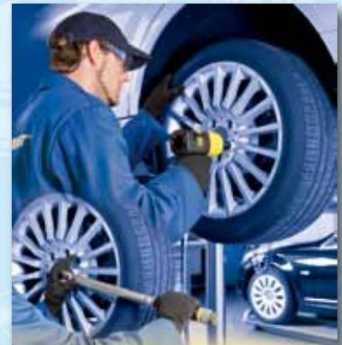
Genauere Momenteinstellung einfach und stufenlos am Handgriff – arretierbar
