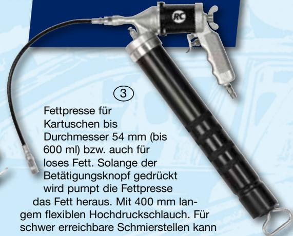
Fettpresse für Kartuschen bis Durchmesser 54 mm (bis 600 ml) bzw. auch für loses Fett. Solange der Betätigungsknopf gedrückt wird pumpt die Fettpresse das Fett heraus. Mit 400 mm langem flexiblen Hochdruckschlauch. Für schwer erreichbare Schmierstellen kann der Griff zum Behälter um 360°gedreht werden.
