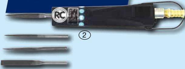
Mit Doppelkolbenantrieb zur Bearbeitung von scharfen Blechkanten, Eisen, Kunststoffen, zum Entgraten und Formen. Inklusive Feilenset mit 4 verschiedenen Feilen (Flach-, Halbrund-, Rund-, Dreiecksfeile). Auch als Linearschleifer umrüstbar mit Schleiffinger LxB = 63x19 mm für Standard 20 mm Bänder (siehe auch Fingerschleifer Modell 6910 S. 37). Hub 5 mm.
