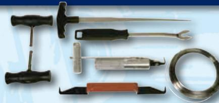
Ausglas-Set zum manuellen Heraustrennen von Windschutzscheiben, Heckscheiben etc. mit Hilfe eines Drahtes quadratischem Querschnitts (0,6 x 0,6 mm) oder Winkelmesser mit Zuggriff. Inklusive Drathaltegriffe, Eintreibdorn, Klammerheber und Zierleistenheber.
