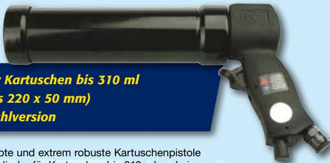
Sehr beliebte und extrem robuste Kartuschenpistole mit Stahlzylinder für Kartuschen bis 310 ml und einer Größe bis zu 220 x 50 mm. Mit regelbarem Luftfluß und Druckentlastung zur präzisen Endabschaltung ohne nachträglichen Materialaustritt. Für Dichtmassen, Silikon, Einkomponentenkleber, Fugenkitte, Spachtelmasse, Fette in Papp-, Alu- und Kunststoffkartuschen
