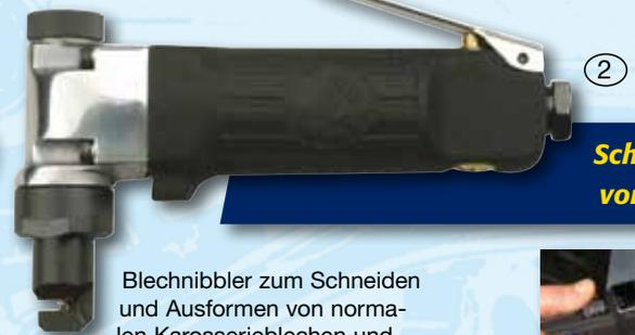
Blechnibbler zum Schneiden und Ausformen von normalen Karosserieblechen und Aluminiumblechen bis zu einer Stärke von 1 mm. Bewältigt mühelos enge Kurven mit einer Schnittbreite von 4 mm und 2,6 m/min. Mit wartungsfreundlichem Deckel zum Nachschmieren und austauschbarer Stanze/Matrize.
